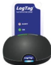
Nachdem Sie einen Logger in ein LTI-WiFi eingesteckt haben, wird dieser automatisch in LogTag Online registriert und im Bereich **Recently Registered Devices** im Dashboard angezeigt.
