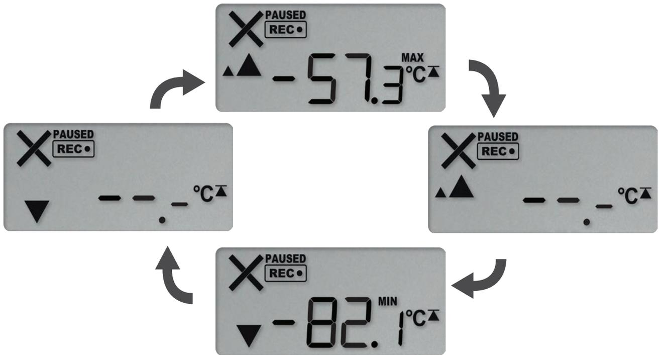
Die aktuell gespeicherten Min/Max-Temperaturwerte können jederzeit während der Aufzeichnung direkt am Gerät zurückgesetzt werden, jedoch nicht nach Ende der Aufzeichnung.
