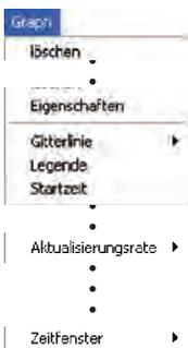
Nach **Stopp** können Sie mit **Löschen** die aufgezeichneten Messwerte und Messkurven löschen.
