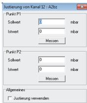
Legen Sie das gewünschte Signal für den Punkt P1 an und klicken Sie auf **Messen**. Der gemessene Istwert wird angezeigt. Geben Sie den dazugehörigen Sollwert für den Punkt P1 ein. Wiederholen Sie diesen Ablauf für P2. Aktivieren Sie die gemachte Justierung über die Checkbox ④. Bestätigen Sie die Wahl mit **OK**.
