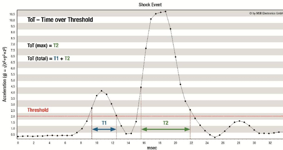
Abbildung 6: Bestimmung der Time over Threshold ToT
