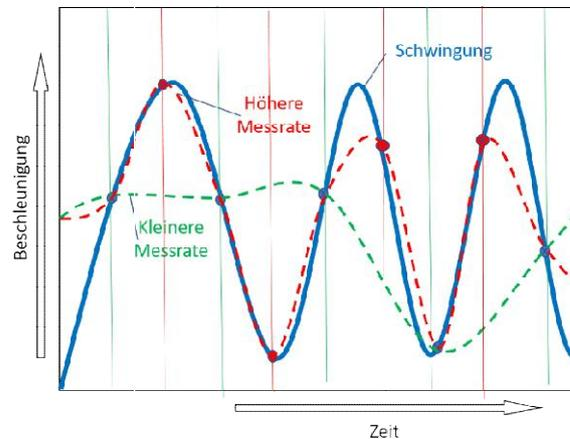
Abbildung 3: Schwingung – aufgelöst mit niedriger und höherer Messrate
