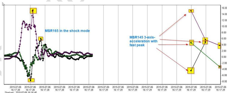
Abbildung 11: Vergleich hohe Messrate vs. Fast Peak - Ereignismaximalwerte
