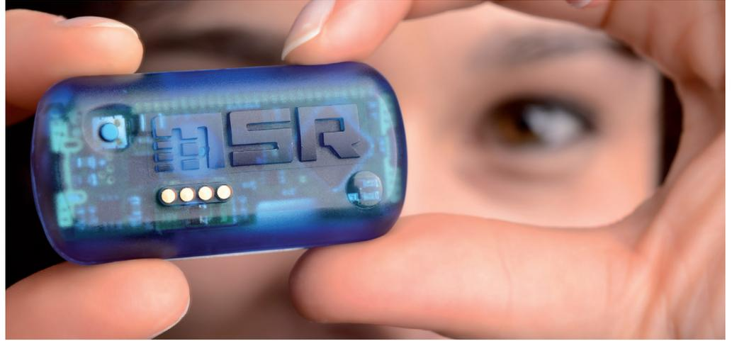
Der kompakte Universal-Datenlogger MSR145 ist in der Lage, mehrere physikalischen Messgrößen wie Temperatur, Feuchte, Luft-/Flüssigkeitsdruck, 3-Achsen-Beschleunigung und Licht über einen langen Zeitraum hinweg zeitgleich zu messen und zu speichern.
