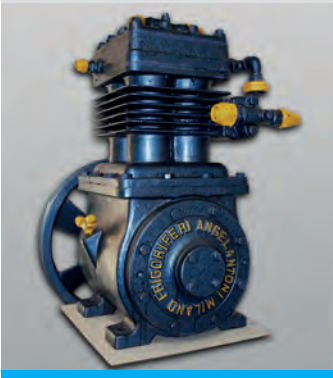
1949 patentierter zweistufiger Kälteverdichter
