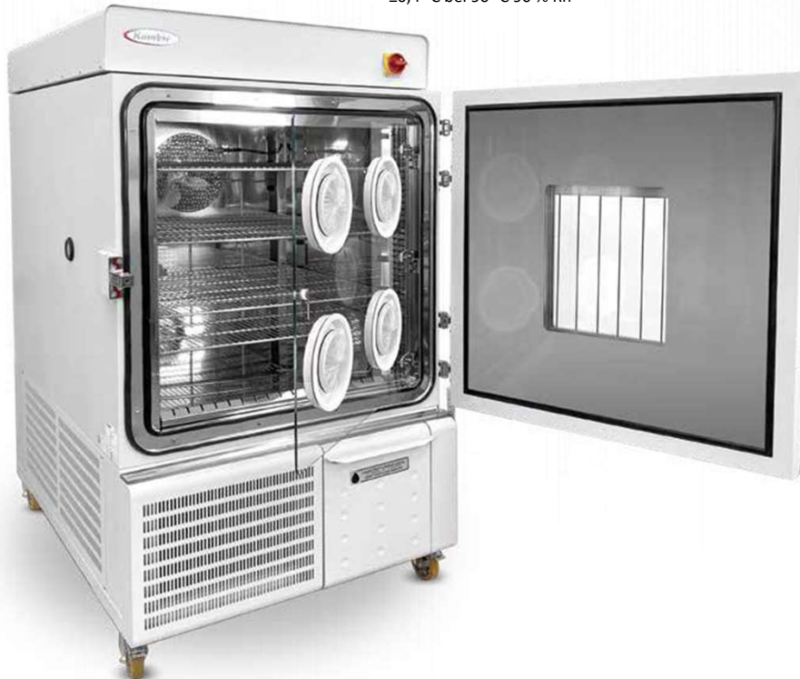
Klimakammer mit entnehmbarer Zwischenglastür und IRIS-Port-Eingriffen
